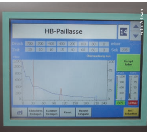
Nah bei der Batterie von Wagenöfen steht die Vakuumkammer, die auf dem Display den Status des Prozesses abbildet. Die Beleuchtung ist direkt in der Tür untergebracht. Ein Personenschutzschalter im hinteren Teil der Kammer sorgt für zusätzliche Sicherheit.
