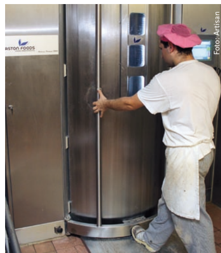
Nach einem Tastendruck beginnt die Pumpe sofort, den Unterdruck zu erzeugen.
