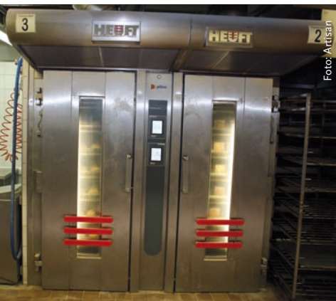
Nah bei der Batterie von Wagenöfen steht die Vakuumkammer, die auf dem Display den Status des Prozesses abbildet. Die Beleuchtung ist direkt in der Tür untergebracht. Ein Personenschutzschalter im hinteren Teil der Kammer sorgt für zusätzliche Sicherheit.
