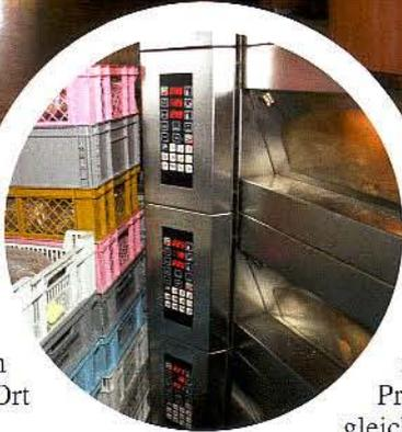
**Gebacken wird in einem von vorn und von hinten zu beschickenden Etagenofen.**
